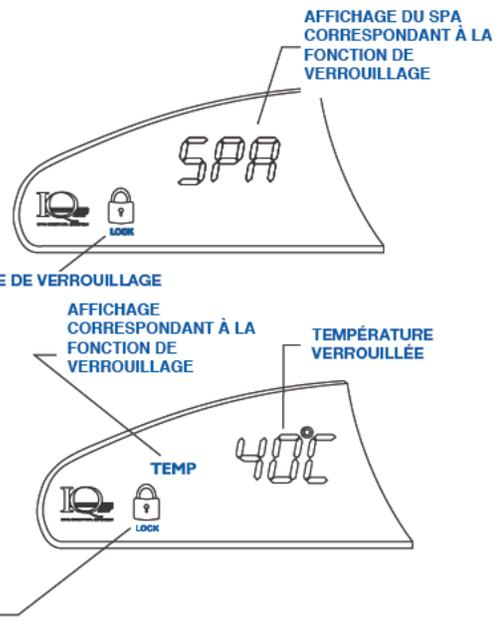
Lorsque la fonction de VERROUILLAGE DE LA TEMPÉRATURE est activée, les touches JETS, LIGHT et CLEAN continuent à fonctionner normalement. Vous pourrez visualiser la température réglée, mais celle-ci NE pourra PAS être modifiée. Si l'on appuie sur une touche de température, le tableau de commande affiche le cadenas et la température réglée pendant 30 secondes avant de s'éteindre.
