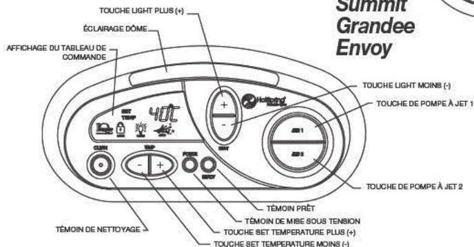
Lorsqu'il fait noir, le tableau de commande principal et l'affichage sont éclairés par une lumière douce placée dans la partie supérieure du tableau.
