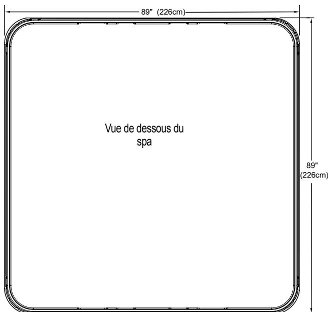
**REMARQUE :** Watkins Manufacturing Corporation exige que le spa *Pulse/DL* soit installé sur une dalle en béton armé d'une épaisseur minimum de 10 cm ou sur une terrasse dotée d'une structure solide capable de supporter le „poids mort“ indiqué dans le tableau des spécifications du spa.
