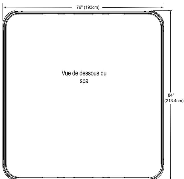
**REMARQUE :** Watkins Manufacturing Corporation exige que le spa *Glow* soit installé sur une dalle en béton armé d'une épaisseur minimum de 10 cm ou sur une terrasse dotée d'une structure solide capable de supporter le „poids mort“ indiqué dans le tableau des spécifications du spa.
