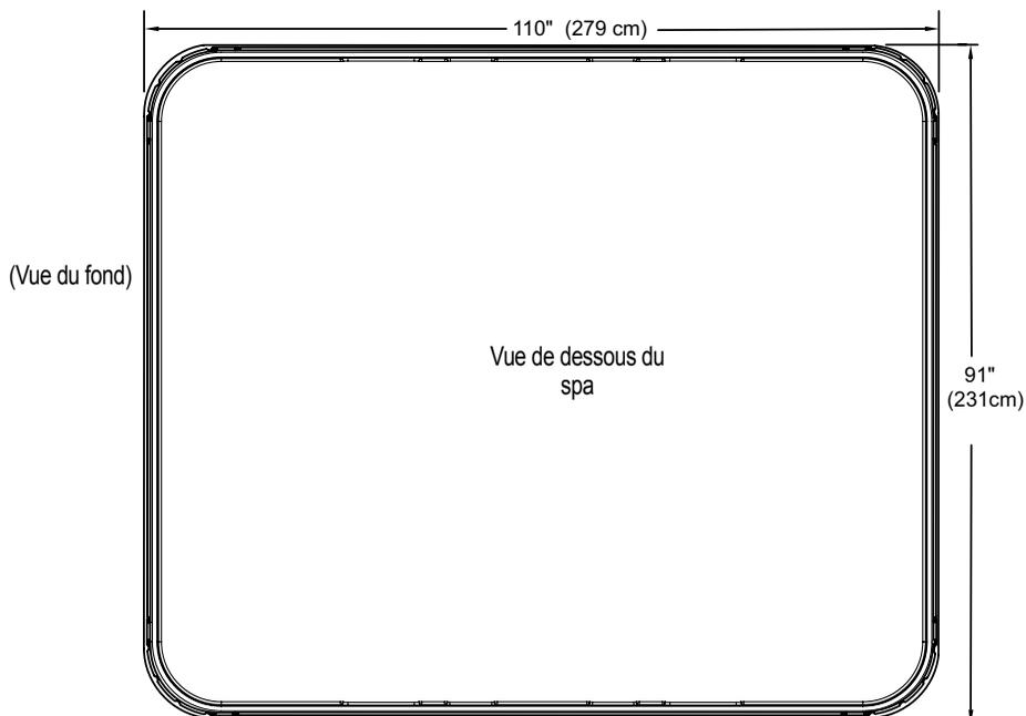
**REMARQUE :** Watkins Manufacturing Corporation exige que le spa *Gleam* soit installé sur une dalle en béton armé d'une épaisseur minimum de 10 cm ou sur une terrasse dotée d'une structure solide capable de supporter le „poids mort“ indiqué dans le tableau des spécifications du spa.
